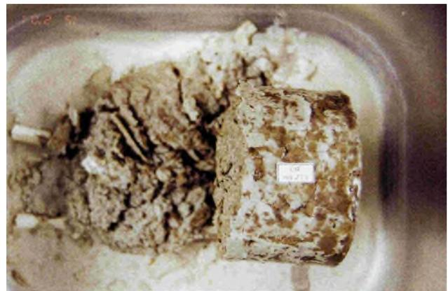
Bild 1 Probenkörper vor Frost-Tau-Wechsel-Untersuchungen – Material: Hafensediment
